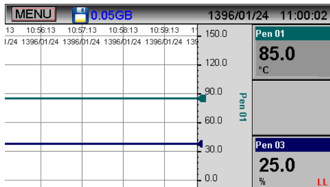
شکل ۱۱-۴: حذف یک قلم از روی صفحه ی نمایش بر اثر صفر شدن قلم متناظر با آن عضو
