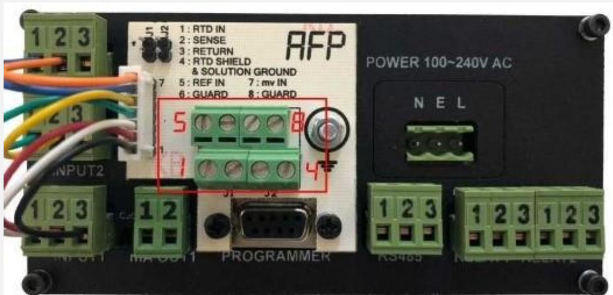
شکل ۱: نما از پشت دستگاه pH meter مدل PR4303
